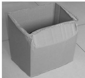
图 4 瓦楞纸板的屈曲破坏
