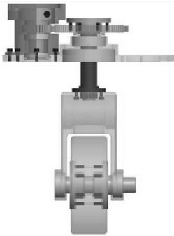
图3 车轮模块转向机构
