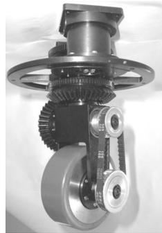
图5 自主移动平台车轮模块
