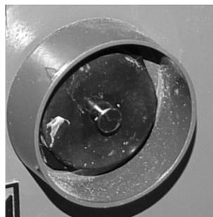
图 2 气压调节阀在一包装箱上的应用
