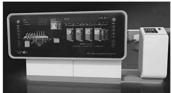
图5 兰达 S 系列数字印刷机触控屏
