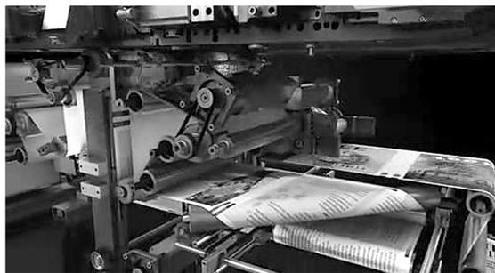
图7 兰达 W 系列数字印刷机双面印刷视图
