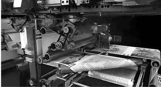
图 8 兰达 W 系列数字印刷机翻转机构视图
