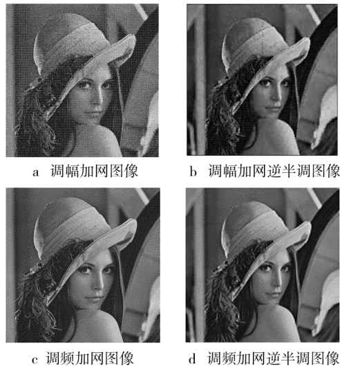
图 3 调幅加网和调频加网逆半调实验图像
