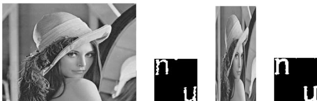
图 8 缩放之后的图像及提取出的水印
