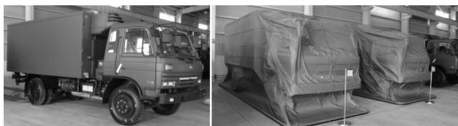
图7 车辆装备整装封存实例
