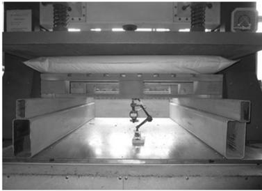
图 2 托盘气囊弯曲试验
