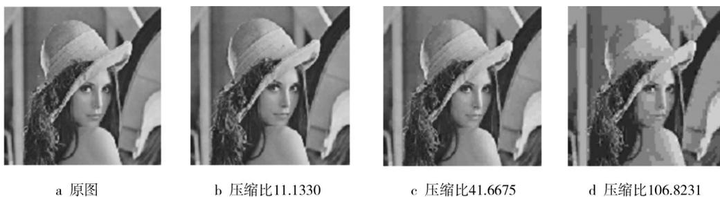
图3 Lena图在不同压缩比下增加反量化补偿矩阵时的解压缩实验结果
