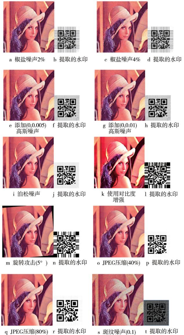
图5 受到攻击后的载体图像与提取的水印图像
