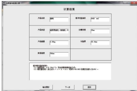
图7 侧面缓冲计算界面
