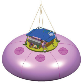
图 5 Exo-Mars 着陆缓冲系统 Fig.5 Exo-Mars airbag landing system
