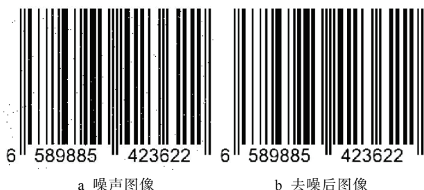
图 1 条码图像中值滤波效果
