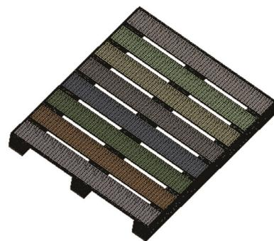
图2 托盘有限元网格模型
