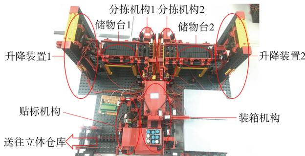
图1 水果包装系统实物模型
