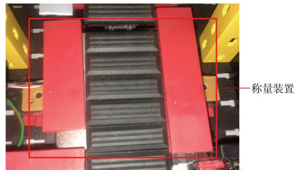
图5 称量装置实物模型
