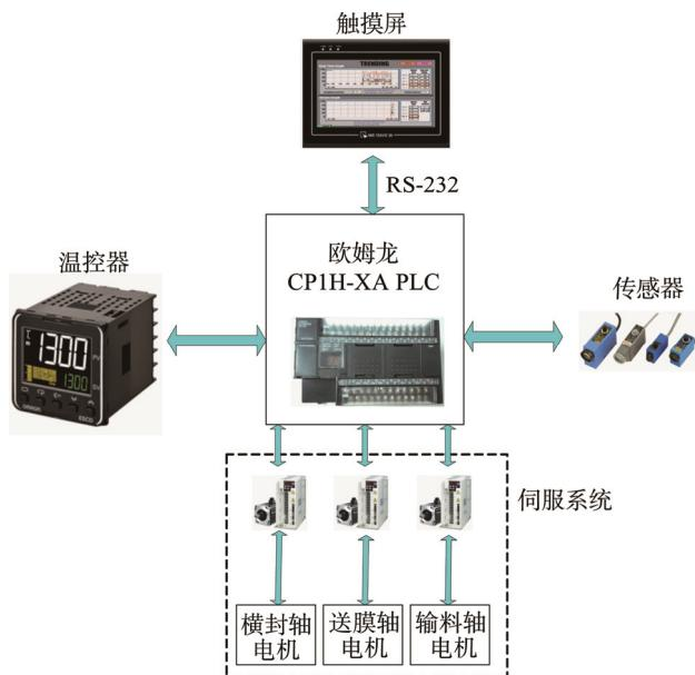
图3 控制系统硬件结构
