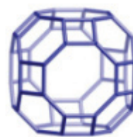
图3 LTA 型单晶胞分子筛 Fig.3 LTA type unit cell molecular sieve
