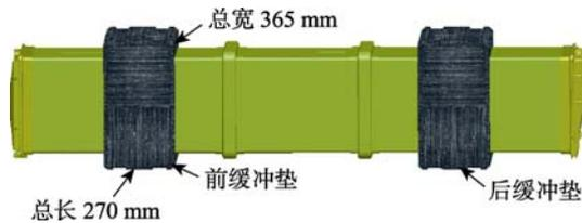
图 2 包装箱缓冲结构
