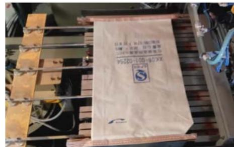
图 3 袋转向机构托放空袋
