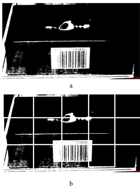
图 13 破损条盒二值化图像分割示例 Fig.13 Broken bar box binary image segmentation example
