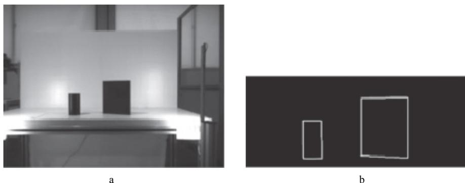
图4 双目 CCD 相机初始图像与边缘提取后的图像
