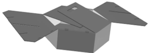
图 4 储运过程中的提手放置状态
