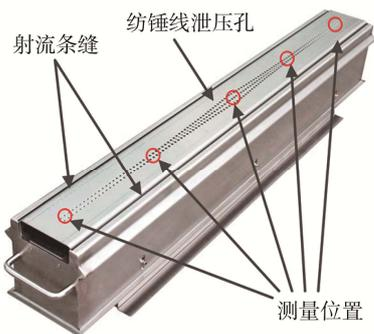
图 12 开泄压孔的射流风嘴
