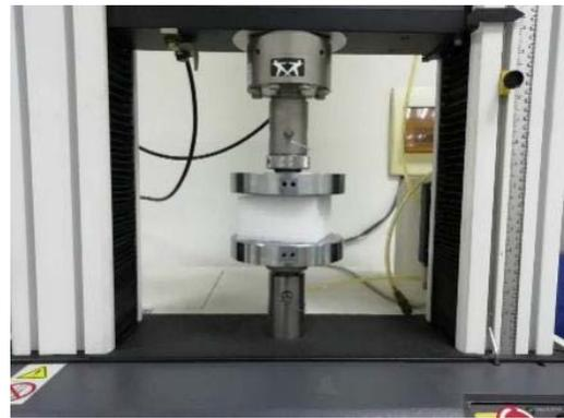
图 1 电子万能试验机
