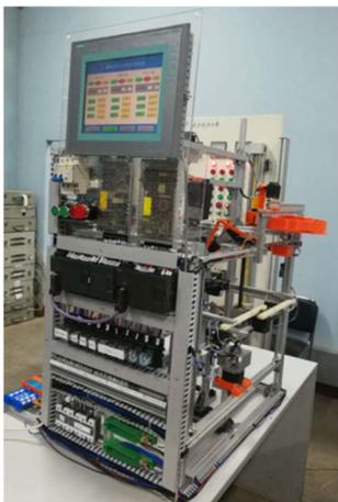
图6 自动包装原型机实物
