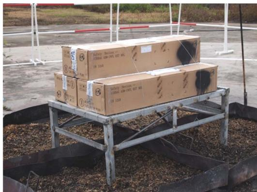
图 2 UN6c 试验样品
