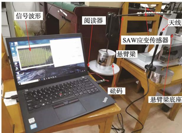
图 6 SAW 回波信号阅读器硬件系统实物连接
