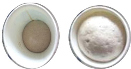
图 2 聚氨酯发泡材料发泡过程
