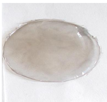
图2 nano-MnO 2 -CS 复合膜实物
