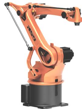
图 1 自动化包装机器人机械手实物
