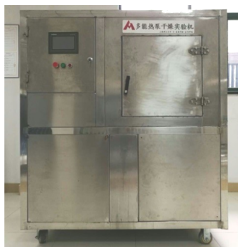
图 2 多功能热泵干燥实验机实物
