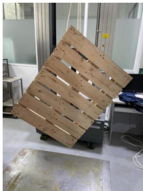
图 17 托盘试件角跌落试验
