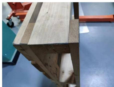
图 18 角跌落试验后托盘外观
