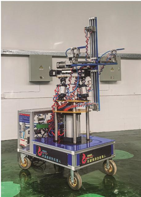
图 12 高效率冷凝器清洗机器人样机
