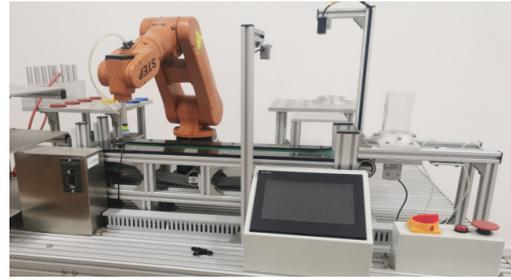
图 3 码垛机器人系统样机
