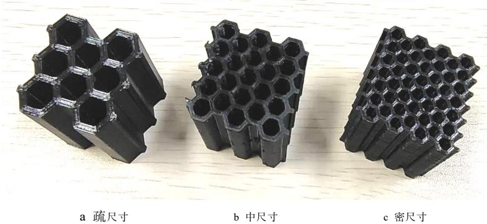
图 17 3D 打印 TPU 材料的正六边形结构 (相对密度为 40%)
