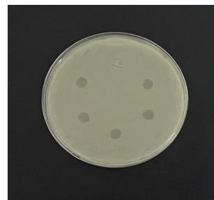
图 5 薄膜对金黄色葡萄球菌抗菌性能
