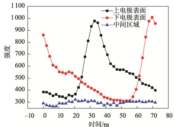
图 6 丝状放电上电极介质表面、中间以及下电极介质表面发光强度随时间的变化
