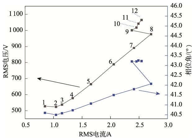
图 2 双介质（放电间隙为 4.4 mm）氩气放电电流电压曲线及电流相位角曲线
