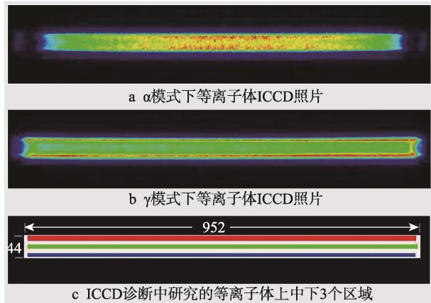
图 3 等离子体 ICCD 照片及 ICCD 诊断示意图
