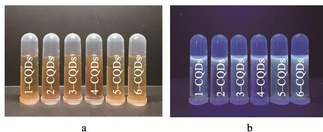
图 1 未掺杂 CQDs 溶液在可见光与紫外光 ( $365\text{ nm}$ ) 激发下的发光对比
