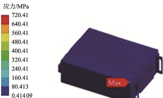
图 4 锂电池裸机跌落等效应力云图
