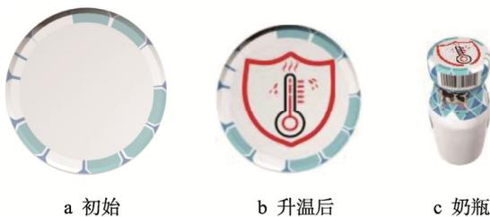
图 7 显色型鲜奶用时间温度指示标签效果
