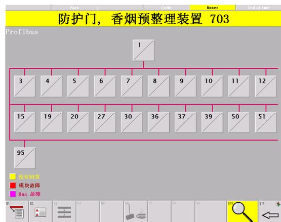
图13 FX2 包装机总线网络
