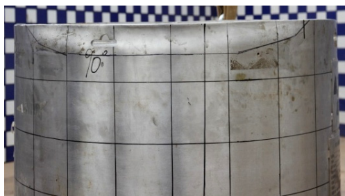
图 4 自由下落试验I变形结果 Fig.4 Deformation result under free drop test I
