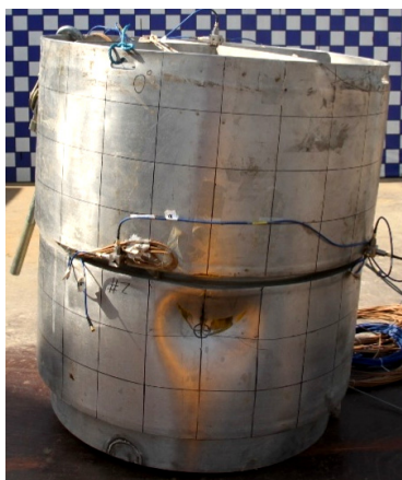
图 6 自由下落试验II变形结果 Fig.6 Deformation result under free drop test II
