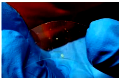
图 2 带有柔性图案的钙钛矿/ PVDF 复合薄膜
