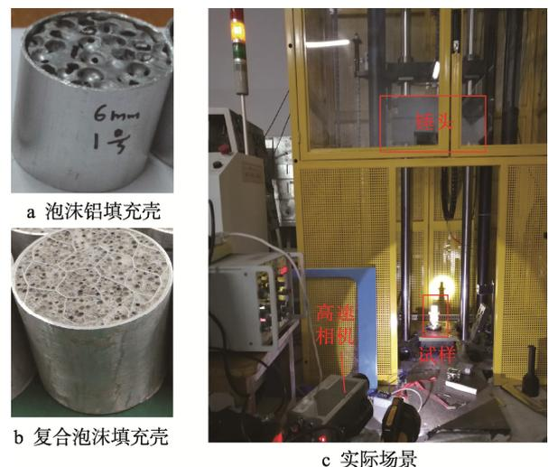
图 2 落锤冲击实验装置及泡沫填充壳
