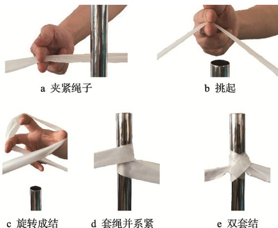
图 1 手工打双套结示意图
