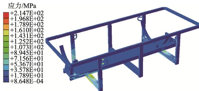
图 13 箱体骨架应力云图
