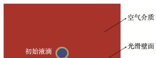
图 2 墨滴撞击壁面的物理模型
