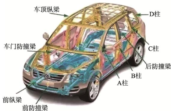
图 1 汽车防撞梁结构
