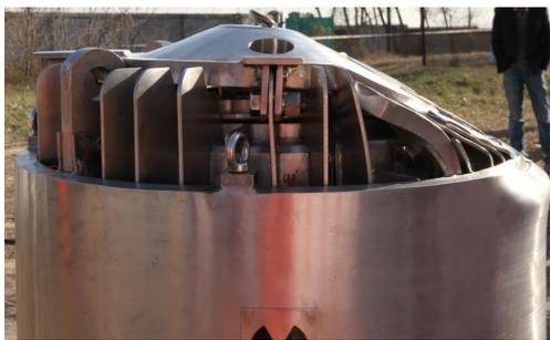
图8 自由下落试验 I 后变形情况
