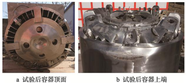
图9 自由下落试验 II 后变形情况
