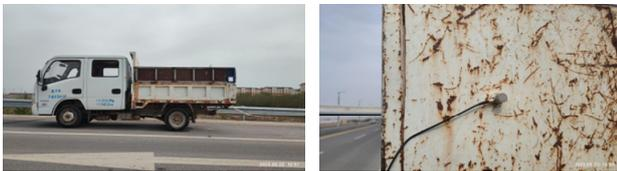
图 3 车辆减速制动工况下冲击载荷波采集试验
